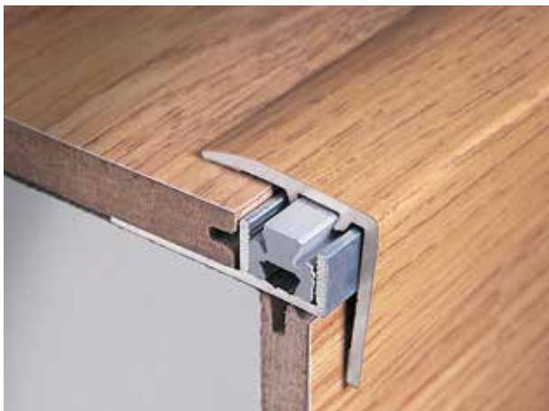
Paragradino brevettato MULTICLIP in grado di completare lo spigolo del gradino, anche con lo stesso materiale del rivestimento, rendendolo più visibile e migliorandone la durata nel tempo. Protegge gli spigoli dell'alzata e della pedata da scalfitture e ne maschera eventuali difetti di taglio ed imprecisioni nell'accostamento.
